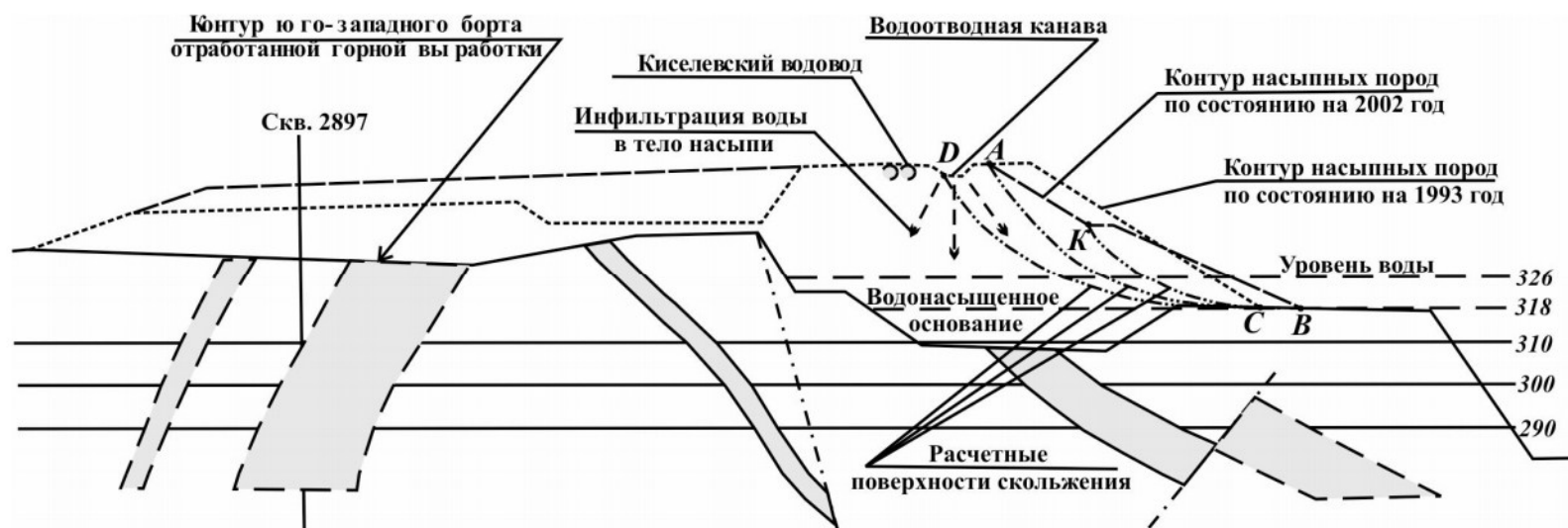
Рис. 1. Схема расположения горных выработок разреза и Киселевского водовода
